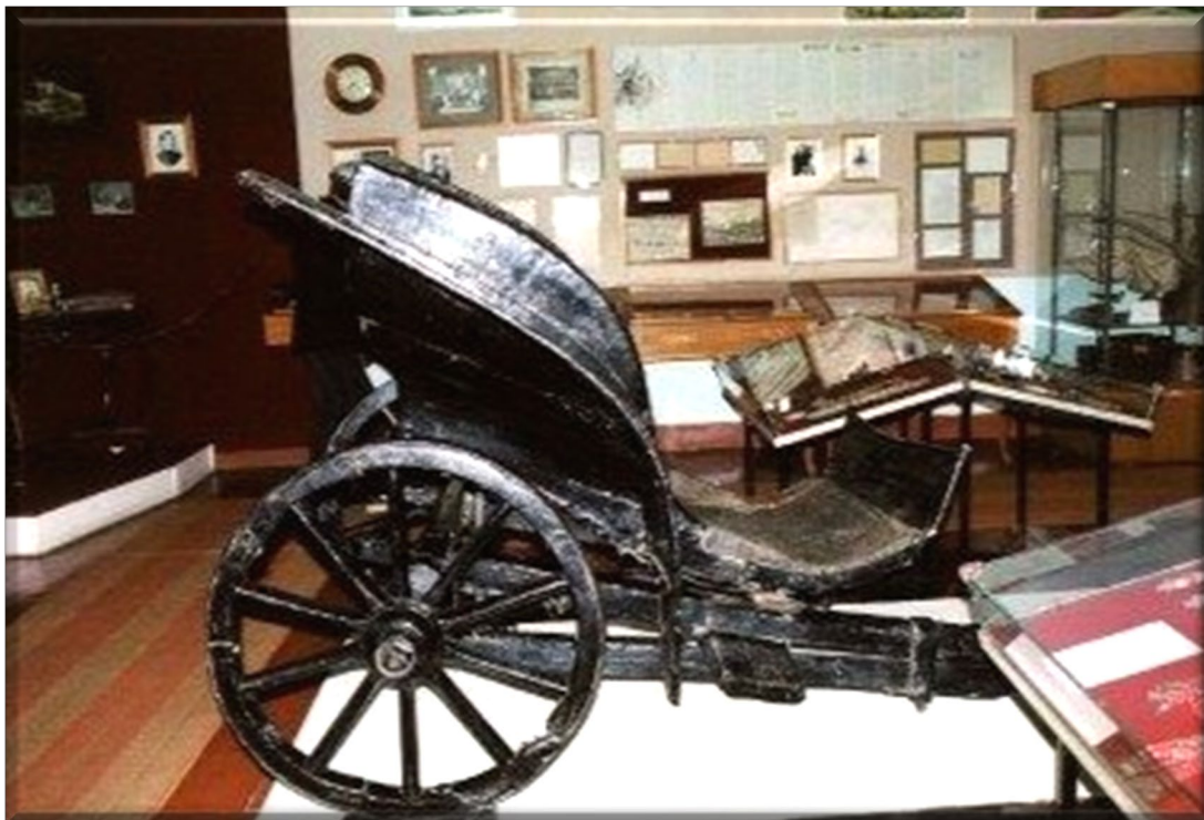
«Бестужевска» - двуколка (двухколёсная конная повозка), изобретённая братьями-декабристами Николаем и Михаилом Бестужевыми.
